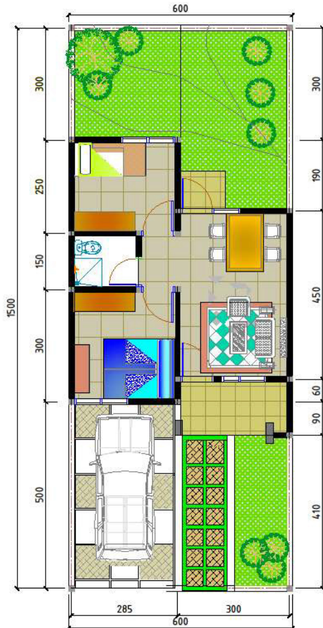
DENAH RUMAH TYPE 36 SKALA 1:100
